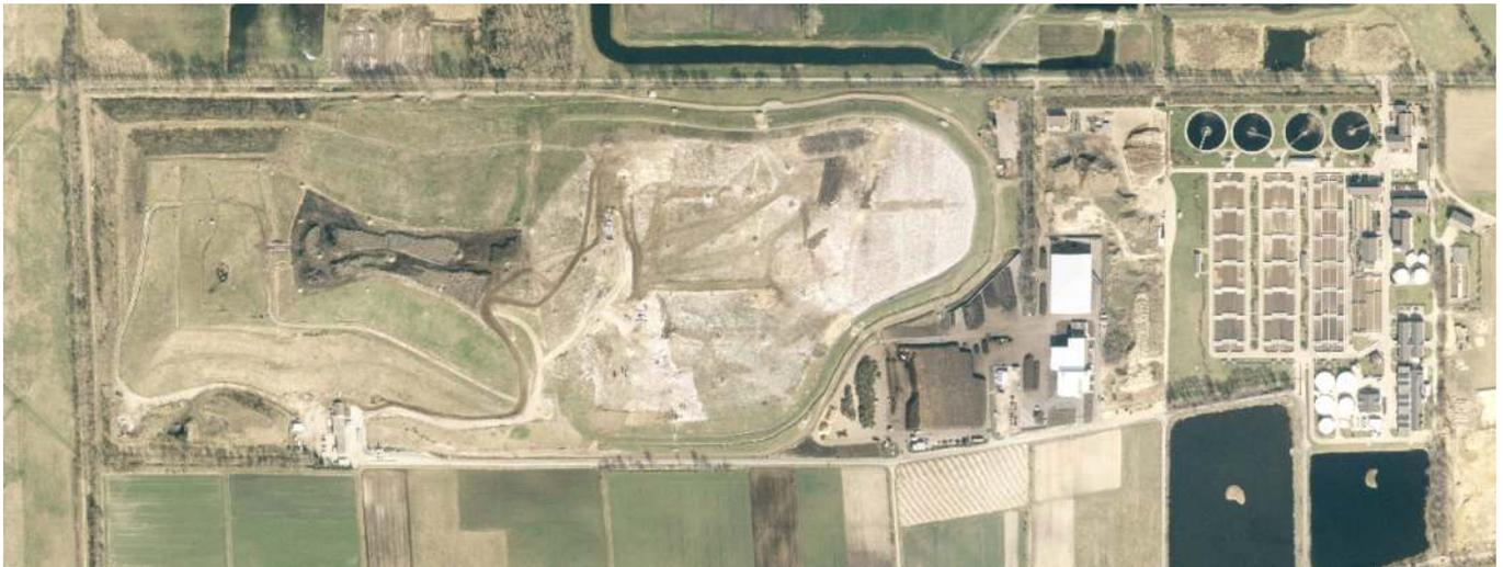
Die Deponie wurde als Haldendeponie angelegt. Die Ablagerung wurde auf vier Schüttfeldern, den Schüttfeldern I, II, IIa und III ausgeführt. Das älteste Schüttfeld (SF) I war von 1967 bis 1980 in Betrieb. Von 1980 bis 1990 erfolgte die Ablagerung in SF II und von 1989 bis 1992 in SF IIa. Das SF III wurde von 1989 bis 2002 betrieben, wobei nur noch bis 1999 nennenswerte Abfallmengen abgelagert wurden.
